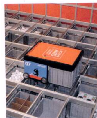
De Autostore kan 700 orders per uur picken. Indien nodig kan Active Ants nog flink uitbreiden
